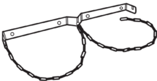
Fig. 37: Fixation de la bouteille de gaz
