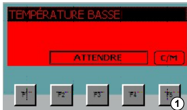
Fig. 32: Message d'alarme BASSE TEMPÉRATURE
