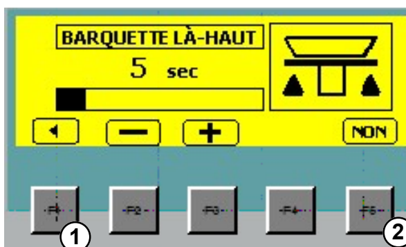
Fig. 21: Désactivation du dispositif de levage du contenant
