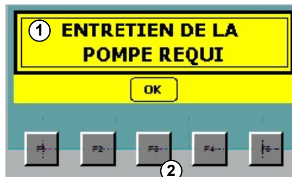
Fig. 34: ENTRETIEN DE LA POMPE REQUI
