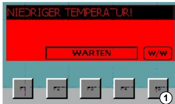
Abb. 32: Alarmanzeige NIEDRIGE TEMPERATUR
