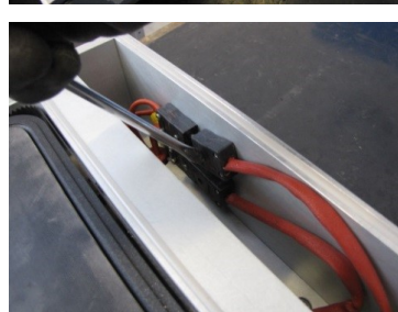
Imm. 37: Scollegamento del collegamento elettrico a spina
