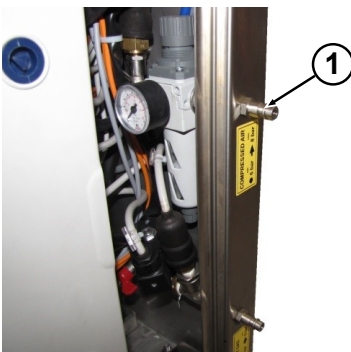
Fig. 10: Raccord rapide pour le raccordement de l'air comprimé
