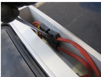
Abb. 37: Elektrische Steckverbindung trennen
