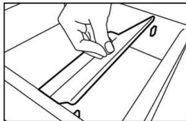
Abb. 9: Schrägeinsatz montieren
