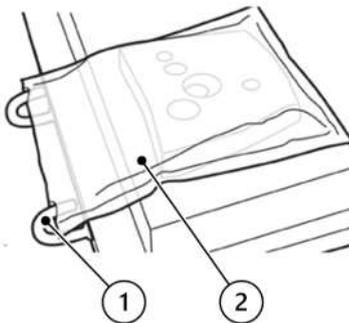
Abb. 11: Gasdüsen platzieren
