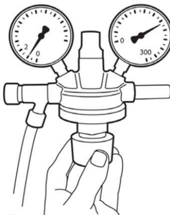
Abb. 12: Ventilarmatur
