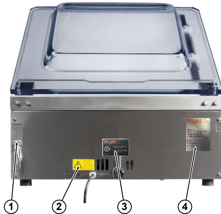
Abb. 1: Warn- und Hinweisschilder an der Maschine
