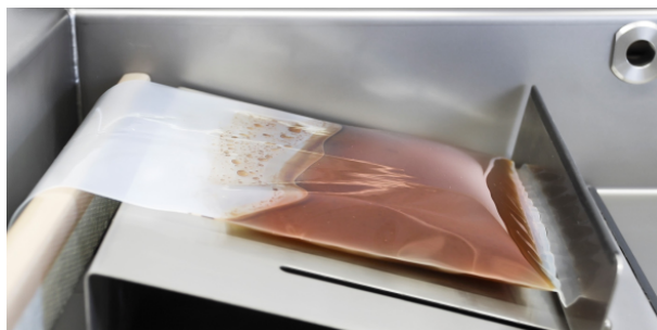
Fig. 9: Mise en place de l'insert d'inclinaison
