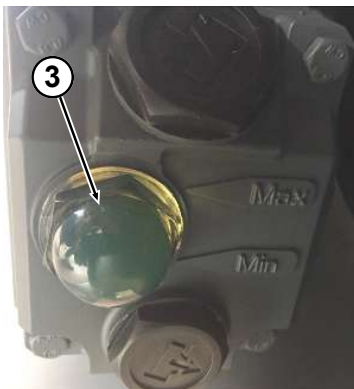
Fig. 19: Vérifier le niveau d'huile
