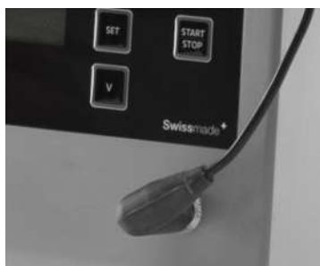
Imm. 8: Collegamento del termometro per alimenti
