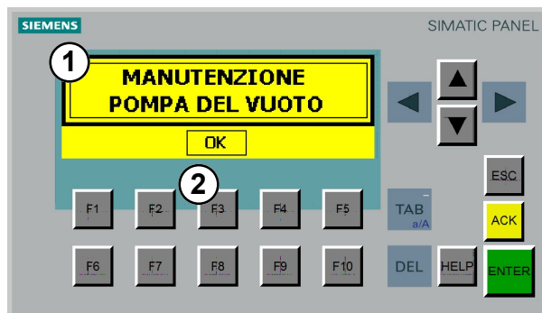
Imm. 17: Manutenzione della pompa
