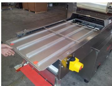
Imm. 71: Rimozione della superficie di carico
