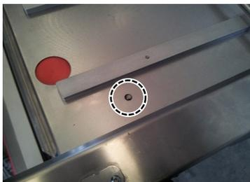
Imm. 72: Bloccaggio della superficie di carico
