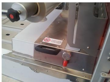
Imm. 68: Bloccaggio del supporto guide
