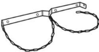
Imm. 9: Protezione della bombola
