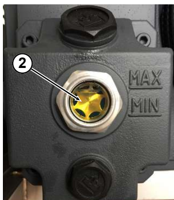
Imm. 15: Verifica del livello dell'olio
