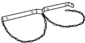
Fig. 10: Fixation de la bouteille de gaz
