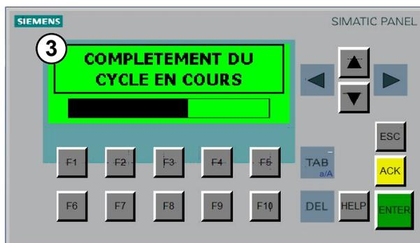
Fig. 13: État des phases du cycle
