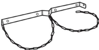
Fig. 28: Fixation de la bouteille de gaz
