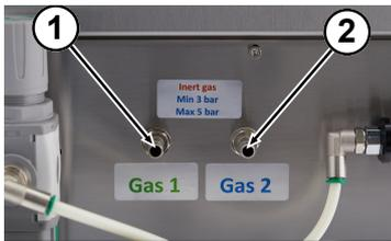
Fig. 27: Raccord de gaz protecteur
