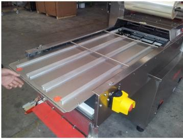
Fig. 71: Retirer la surface de chargement
