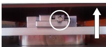
Fig. 45: Boulon de blocage
