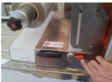
Fig. 62: Déverrouillage du support de coulisse
