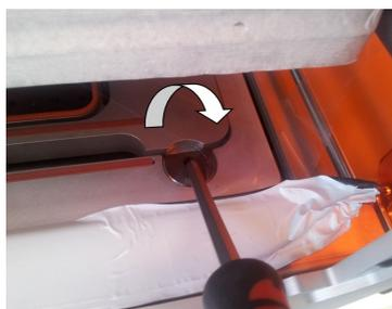
Fig. 59: Verrouillage du support de barquette
